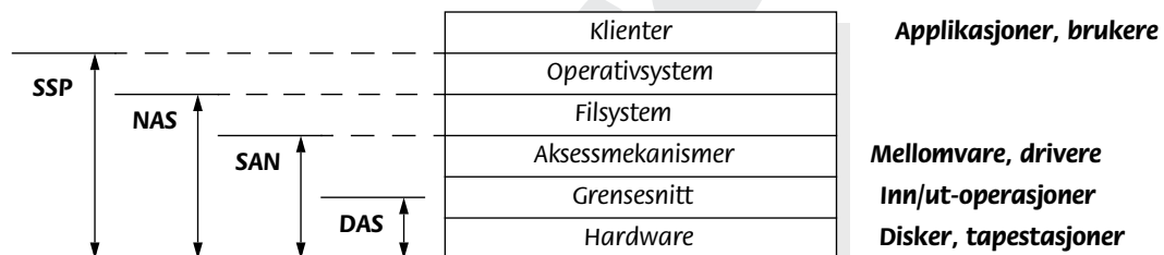
Figur 1 Et lagringssystem kan deles inn i nivåer der vi begynner på toppen – med en lagringstjeneste for objekter som en applikasjon kan forholde seg til, og går helt ned til bitstrømmen som leses og skrives med ufattelig nøyaktighet på roterende, magnetiske plater.
